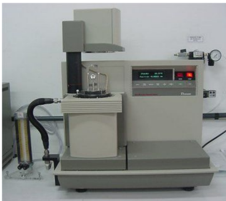
Figura 17: Exemplo de equipamento utilizado para análise DMA.
