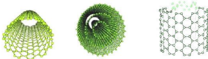
Figura 8: Nanotubos de carbono nos formatos parede simples(SWCNT), parede múltipla(MWCNT) e parede dupla(DWCNT), respectivamente[11]
