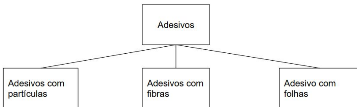
Figura 3: Tipo de reforços em um adesivo[1]
